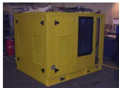
Châssis-capot groupe hydraulique Diesel
